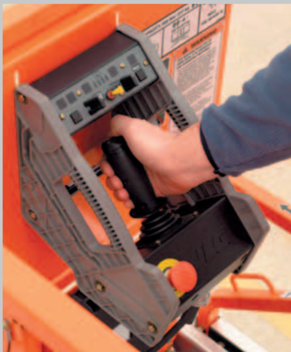
Vollkommen proportionale Steuerung der Antriebs- und Hubfunktionen
