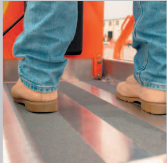
Die Arbeitsplattform aus hochwertigem, korrosionsfestem Aluminium verfügt über Antirutsch-Streifen, damit Bedienpersonen einen sicheren Stand haben
