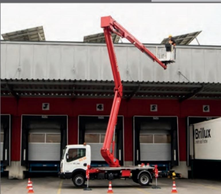
Mit der ECOLINE RS 240 können herausragende **24 Meter Arbeitshöhe** erreicht werden. Die Gelenk-Teleskop-Bühne bietet in der „**low budget**“- Angebotsreihe enorme Anwendungsflexibilität und -möglichkeiten. Seit Einführung im Frühjahr 2017 erfreut sie sich großer Beliebtheit und ist europaweit im Einsatz.
