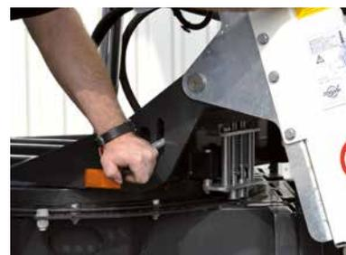
Verstellbarer Drehkranz mit mechanisch lösbarer Sperre
