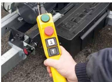
Elektrische Steuerung mit Schleifgang (optional)
