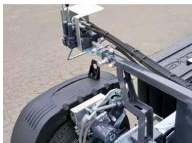
Formschlüssiger, leistungsstarker Selbstfahrtrieb (optional)
